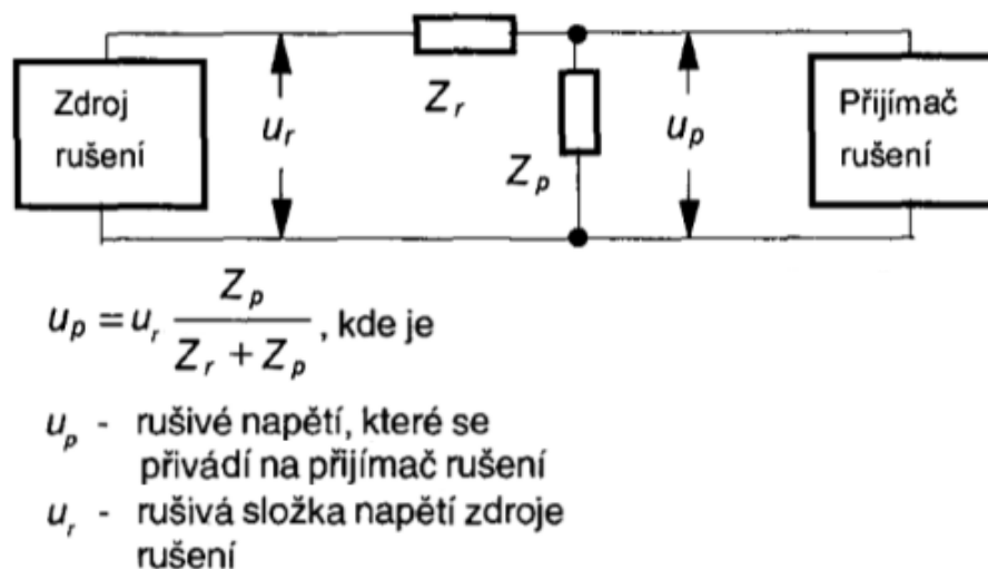
Obr. 2.3: Vazba společnou impedancí mezi zdrojem rušení a přijímačem rušení [3]
