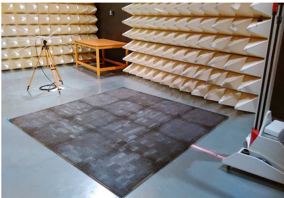
Obr. A.2: Měřicí stanoviště v uspořádání s feritovou podlahou
