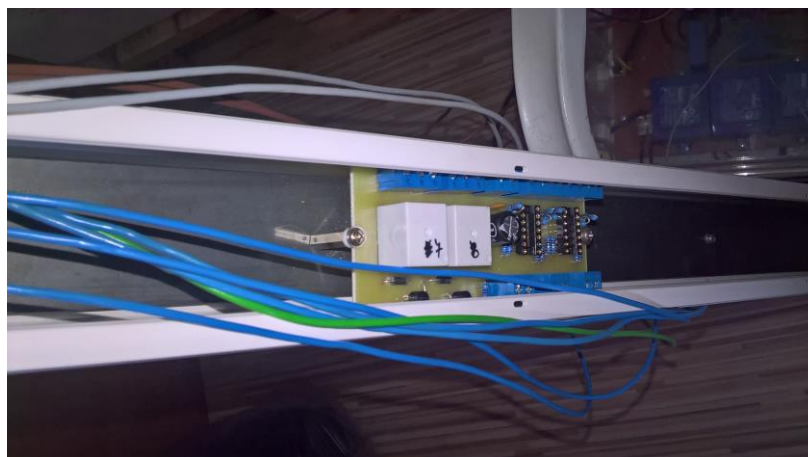
Obr. 3.12 umístění plošného spoje v instalační liště
