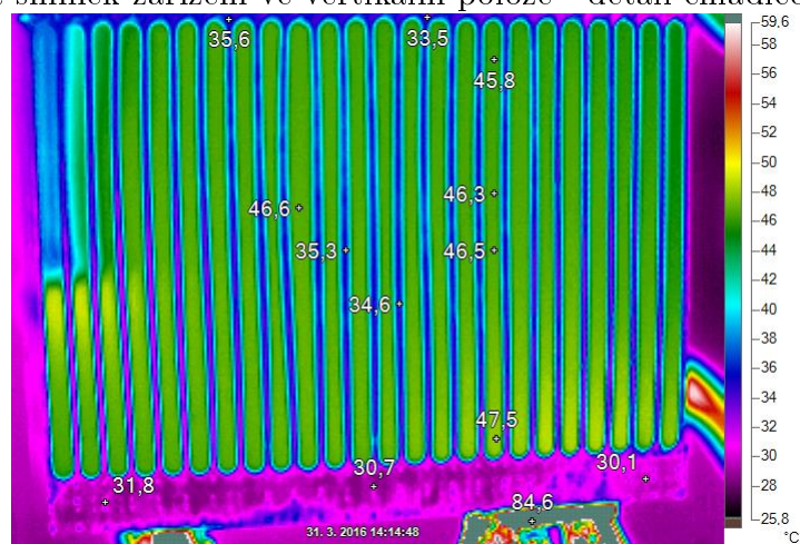
Příloha C.3 IR snímek zařízení ve vertikální poloze - detail chladiče
