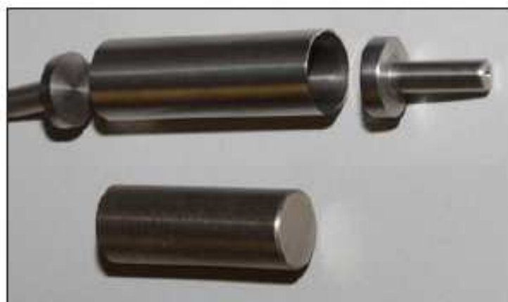
Obr. 3.11 Uspořádání rotoru motoru EC 22 HD (nahore je možno vidět ocelové pouzdro s čepy hřídele, dole vysokoteplotní magnet) Obrázek převzat v nezměněné formě z [12]
