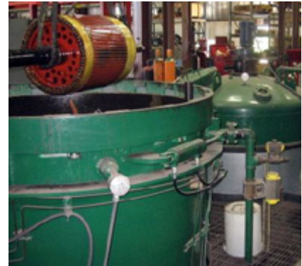
Obr. 2.2 Nádobu pro technologii VPI, převzato z [8]
