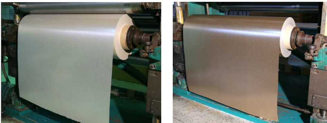
Obr. 3.1 Slídový papír z muskovitu (vlevo) a z flogopitu (vpravo), převzato z [7]
