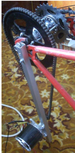
4-1 Připojení motoru k rotopedu
