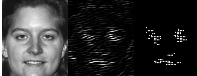
Obrázek 6.9: Aplikace výchozích parametrů GF na obličej z databáze FERET. Zleva: originál, filtrovaný obrázek, vizualizace nalezených bodů.
