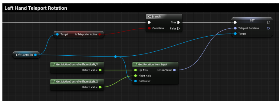
Obrázek 2.5: Ukázka bluepruntu z Unreal Engineu pro obsluhu teleportace pomocí levé ruky.
