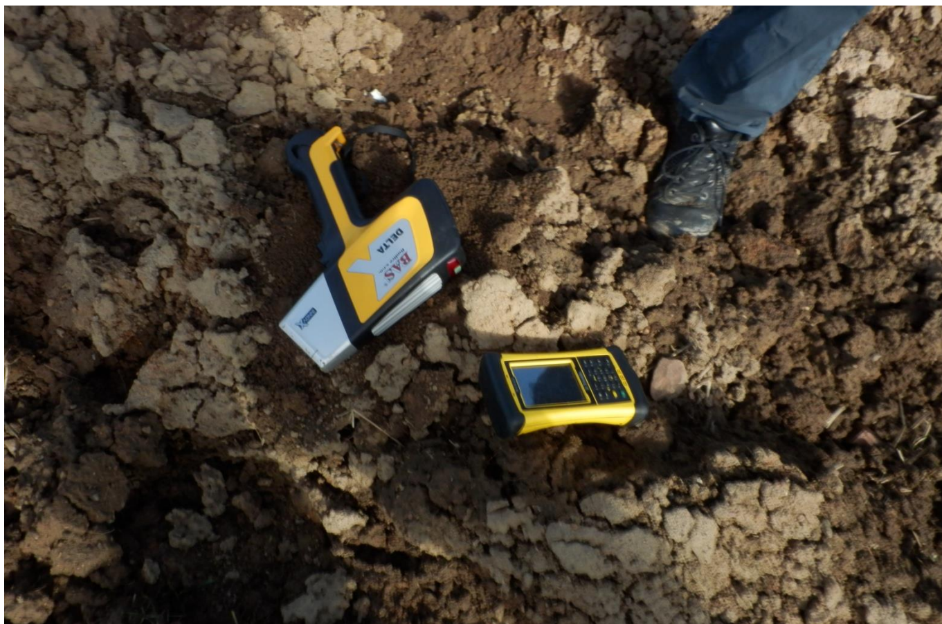
Obr. 17 – Použité přístroje během terénního měření (GPS stanice Trimble Nomad a přenosný spektrometr Olympus Delta)
