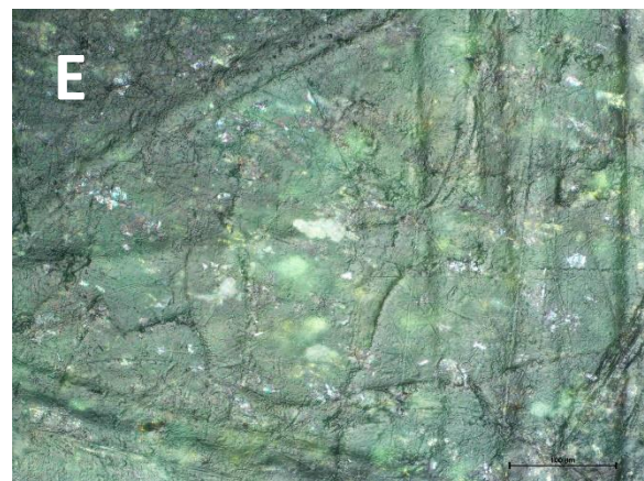
D - drobné rýhy v těsné blízkosti očka (KV_tyj_B_130x127) E - velmi drobné rýhy pozorovatelné při zvětšení 20x (KV_ostri_A_9)
