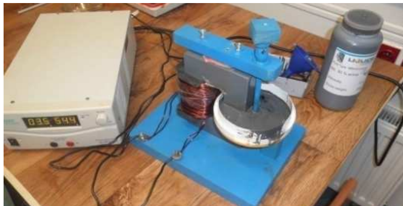
OBRÁZEK 13: PRVNÍ PROTOTYP MAGNETORHEOLOGICKÉ BRZDY
