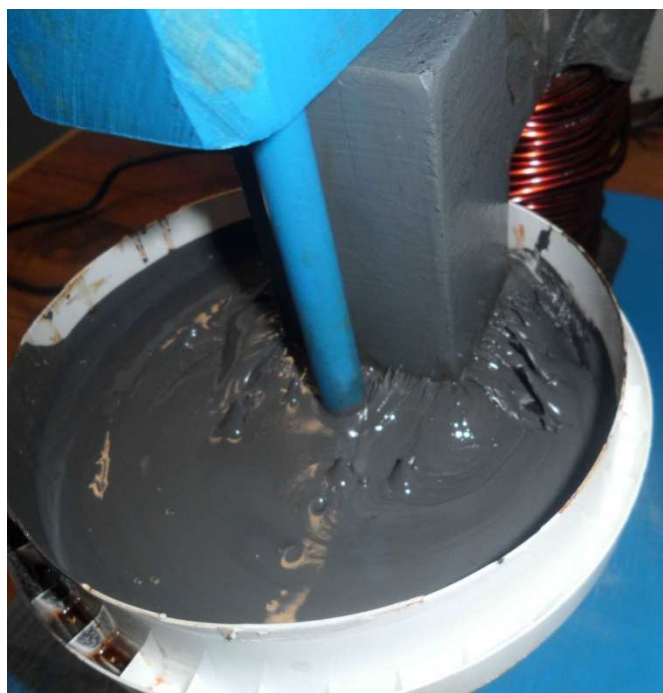
OBRÁZEK 20: REAKCE MR KAPALINY NA MAGNETICKÉ POLE
