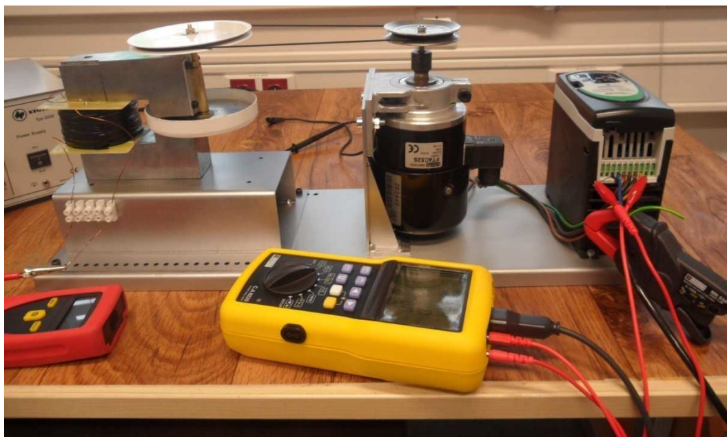
OBRÁZEK 22: MR BRZDA SE ZAPOJENÝMI PŘÍSTROJI
