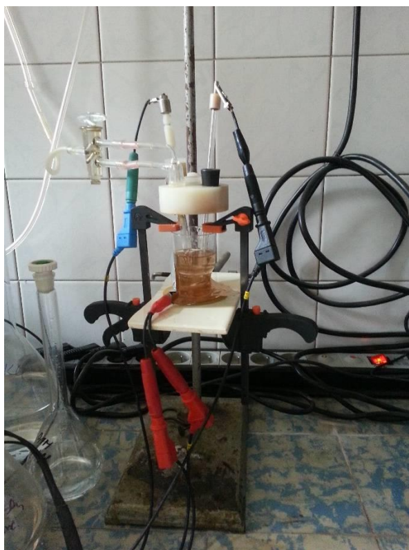
Obrázek č. 7: Elektrochemická cela se zlatou folií
