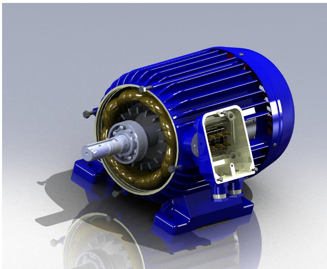
Izometrický pohled (demontovaný čelní štít a kryt svorkovnice)
