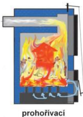
Obr. 2-3 Kotel prohořivací (převzato z:[5])
