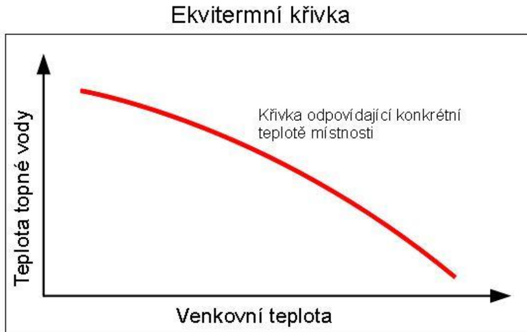
Obr. 4-3 Ekvitermní křivka (převzato z:[20])
