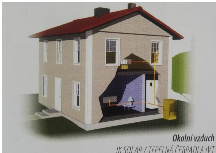
Obr. 2-8 Čerpadlo se systémem vzduch-voda (převzato z:[4])
