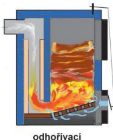
Obr. 2-2 Kotel odhořivací (převzato z:[5])
