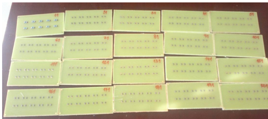
Obr. 13: Všech dvacet DPS po nanesení pájecí pasty, vzorek č.11 již i osazen součástkami
