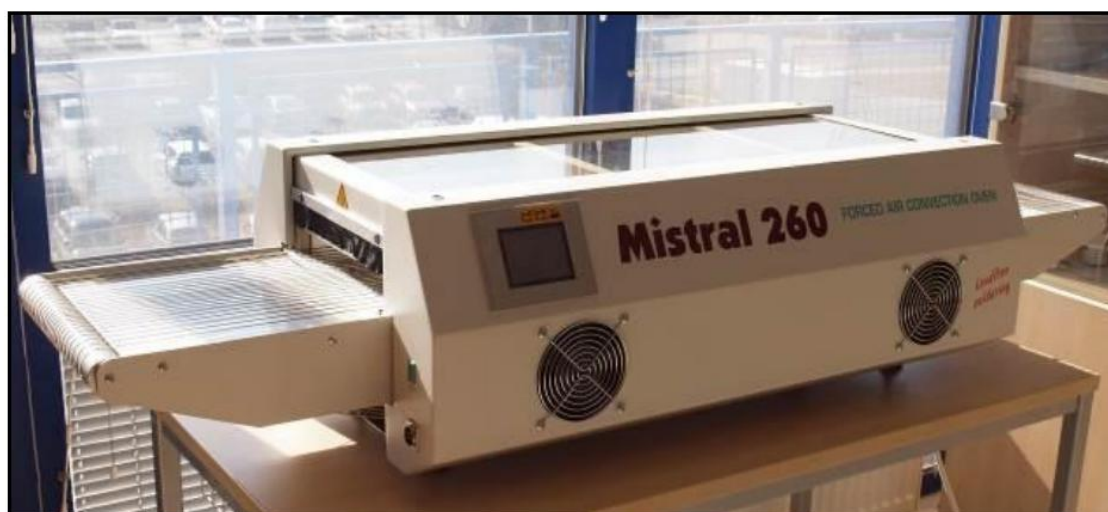
Obr. 17: Použitá horkovzdušná pec Mistral 260 (obrázek převzat z [28])
