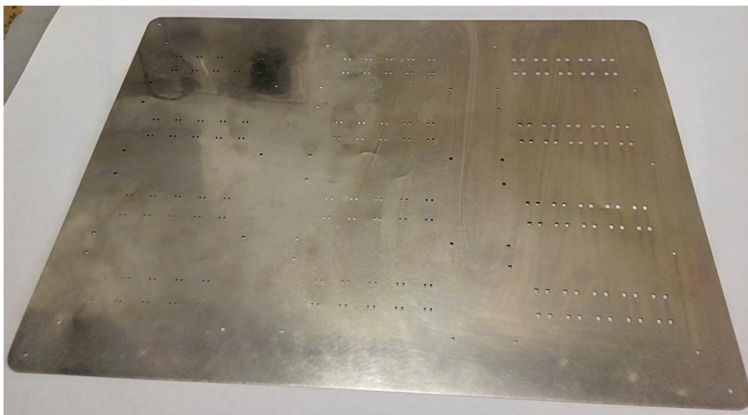
Obr. 15: Jedna z šablon, která slouží k nanášení pájecí pasty na DPS
