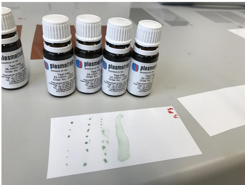
Obr. 16: Příklad špatné (vlevo) a dobré smáčivosti (vpravo) po aplikaci testovacích inkoustů s různými povrchovými napětími na PET Melinex White
