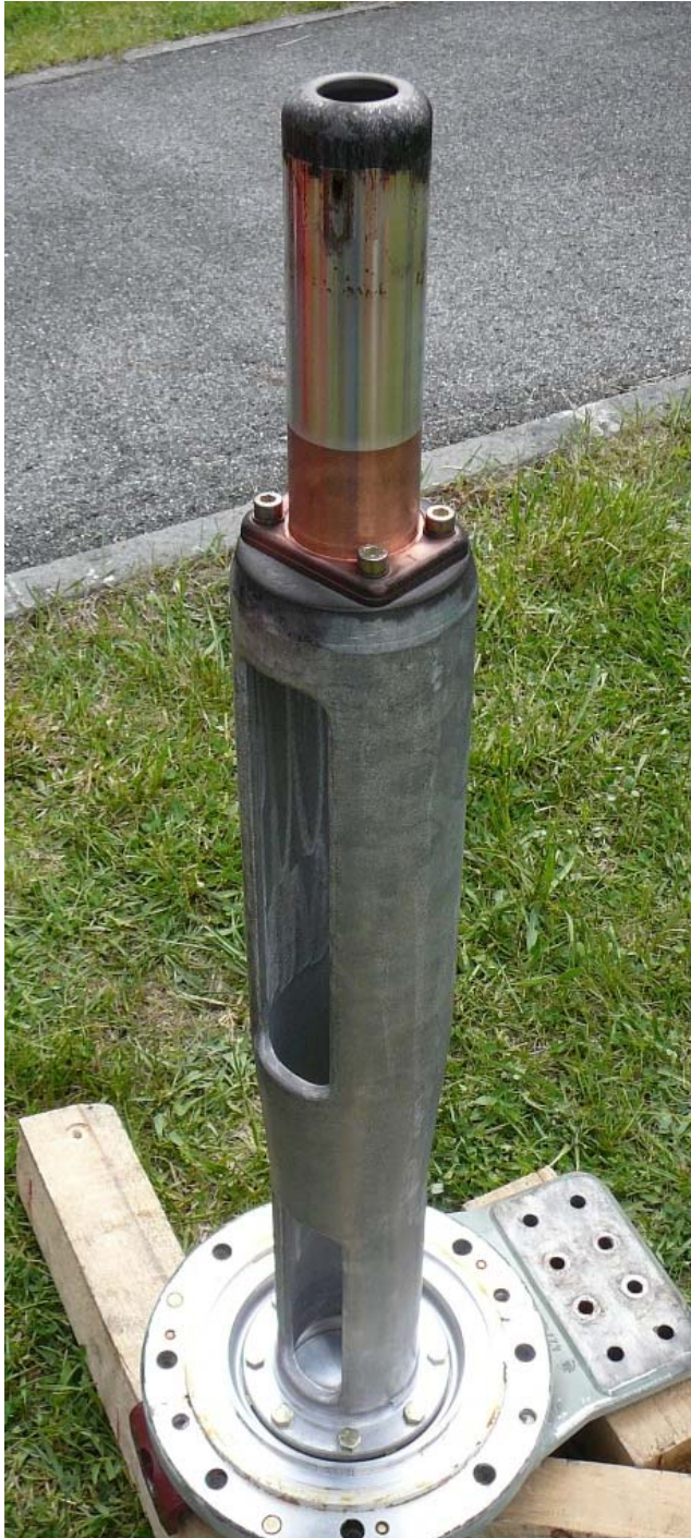
Obr. B.1: Fotodokumentace opotřebení pevného kontaktu vypínače Siemens, typ 3AQ1EE-245kV
