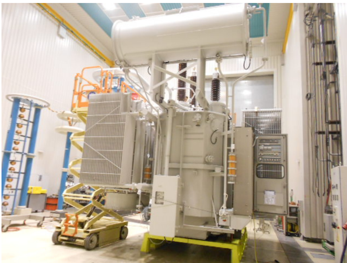
Obrázek 2-boční pohled na třífázový olejový výkonový transformátor
