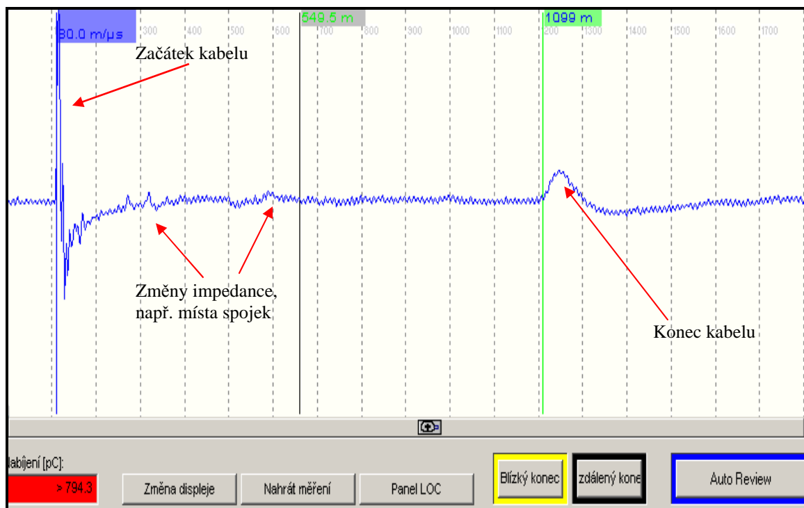
Obr. 10 Zobrazení průběhu při kalibraci
