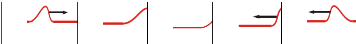
Obr. 26 Princip odrazu vlny s volným koncem[9]
