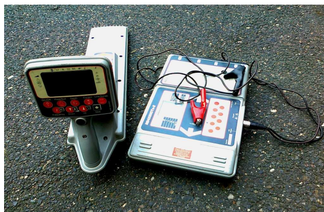
Obr. 32 Souprava pro vytyčení kabelové trasy
