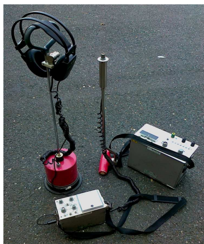
Obr. 31 Souprava zemního mikrofonu a generátoru pro vytyčení trasy
