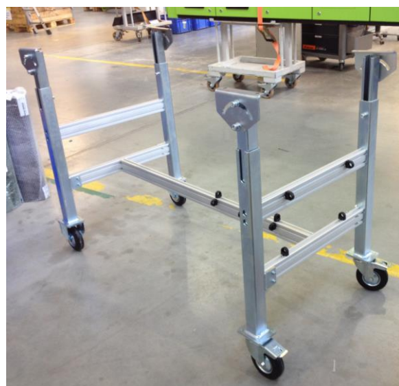
Hotový podvozek dopravníku FB60
