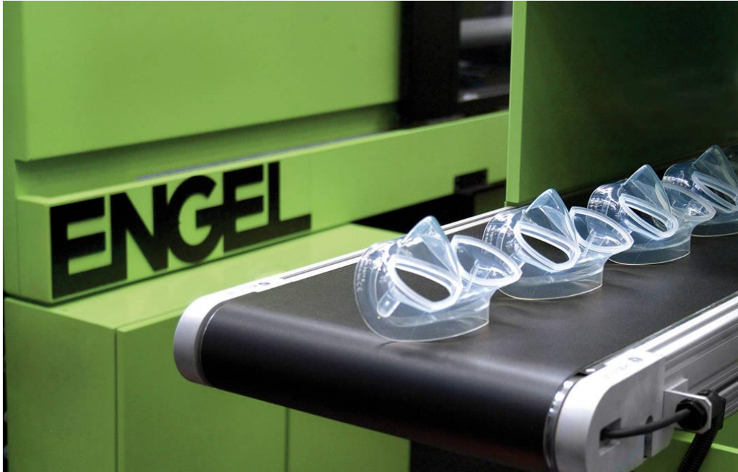
Obr. 27 - Aplikace pásového dopravníku u vstřikovacího lisu ENGEL [16]
