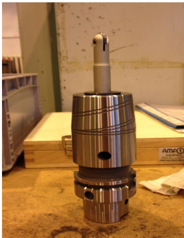
obrázek 3.3- upnutí nástroje hydraulickým upínačem
