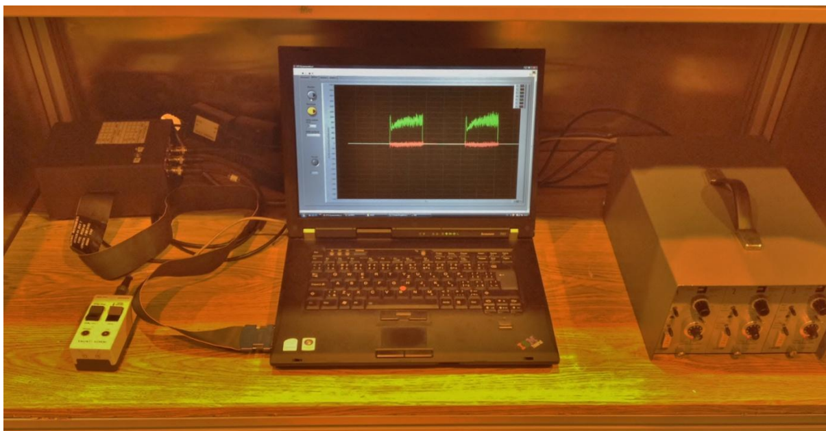
obrázek 3.13-aparatura k měření řezných sil
