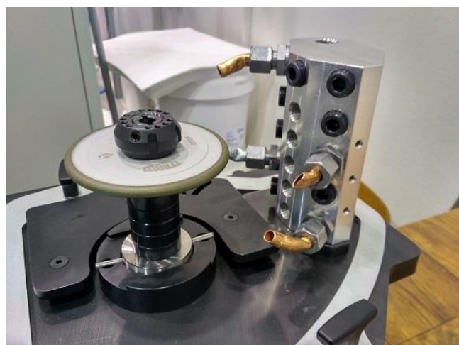
Obr. 41 Sestava brusný kotouč + kazeta s přívodem chlazení
