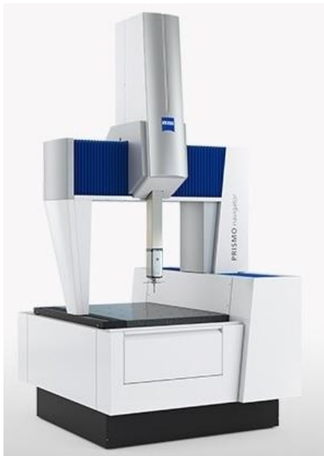
Obr. 29 Souřadnicový měřicí stroj ZEISS PRISMO [23]
