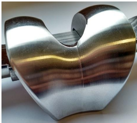
Obr. 75 Součást po broušení s hodnotou sc = 0,005 mm
