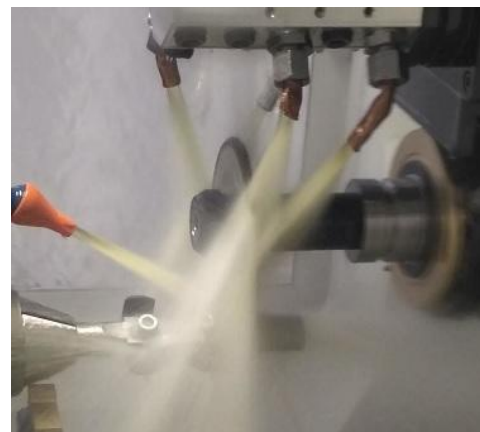
Obr. 72 Viditelnost v pracovním prostoru při broušení
