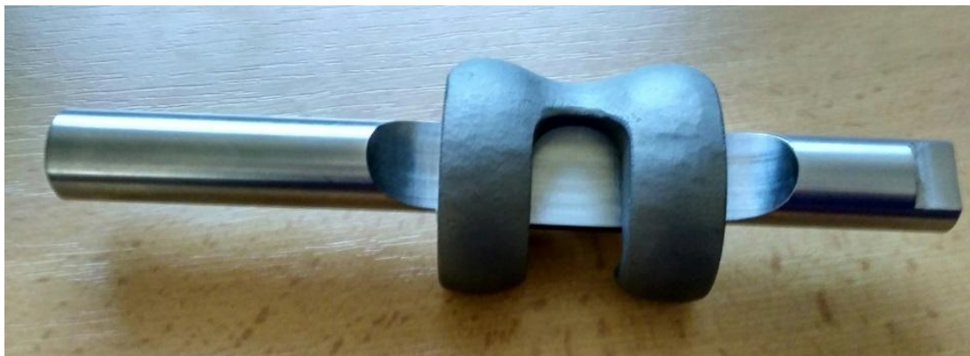
Obr. 54 Vyrobená finální verze upínacího přípravku s upnutou součástí Knee_implant
