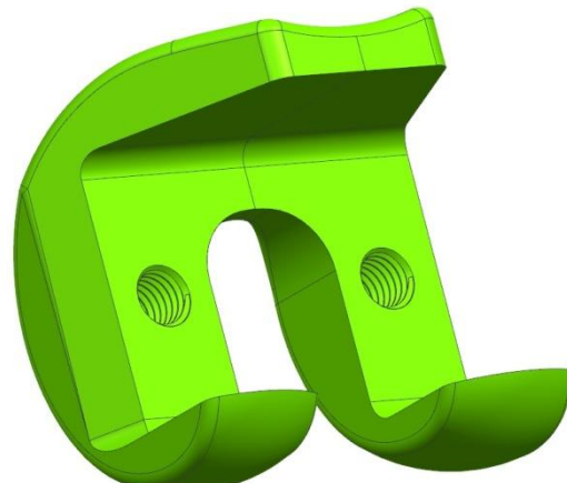
Obr. 50 Přidání dvou závitových otvorů na součást
