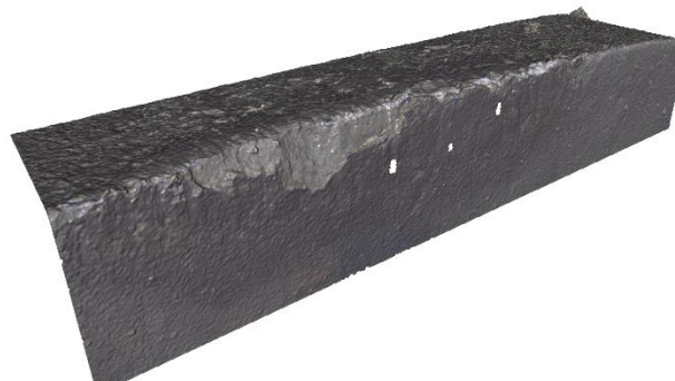
Obrázek 69 - Vydrolování ostří u VBD č. 3
