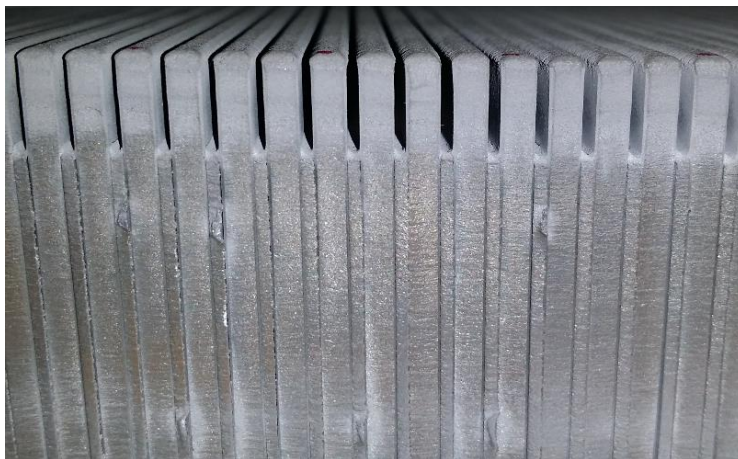
Obrázek 54 - Detail ocelových plátů se stelitovým nástřikem
