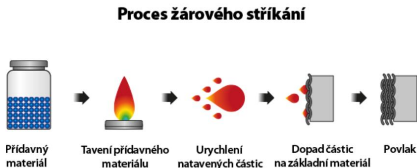
Obrázek 3 - Proces žárového stříkání [11]
