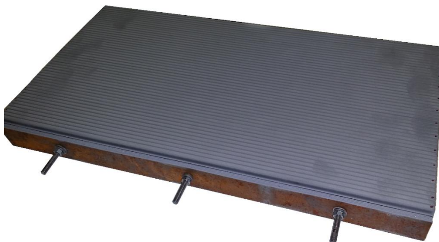
Obrázek 53 - Soustava plátů po nanesení nástřiku metodou HVOF
