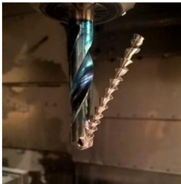
Obr. 29 - Nalepená tříška na nástroji z materiálu M4 s tenkou vrstvou (2-B)
