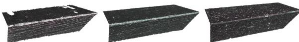
Obr. 15 - 3D analýza břitu
