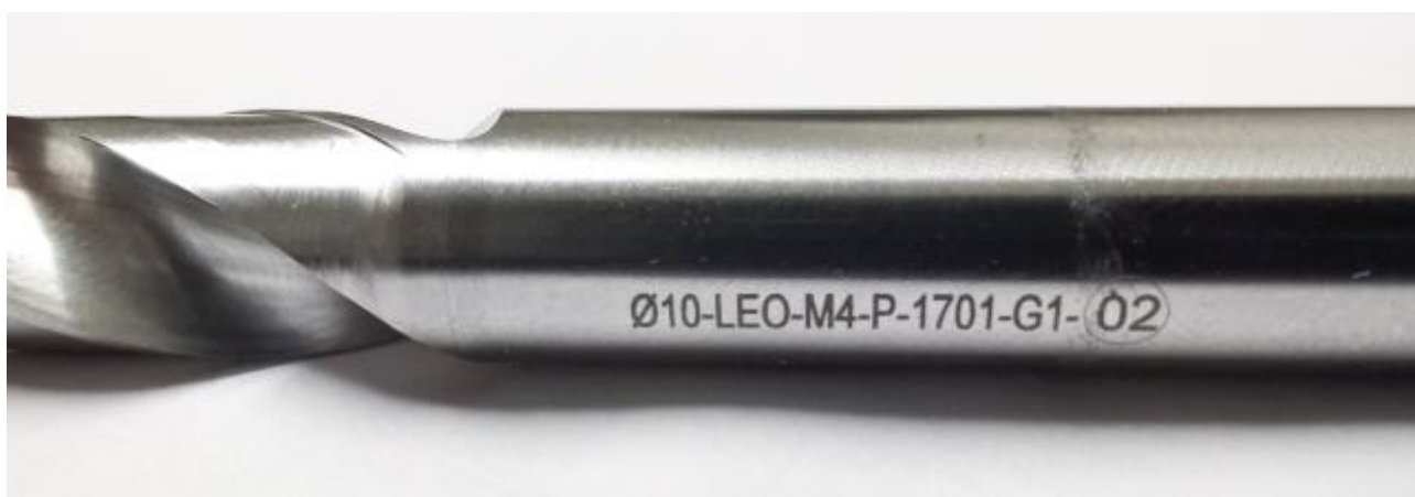
Obr. 14 - Označení nástrojů laserem
