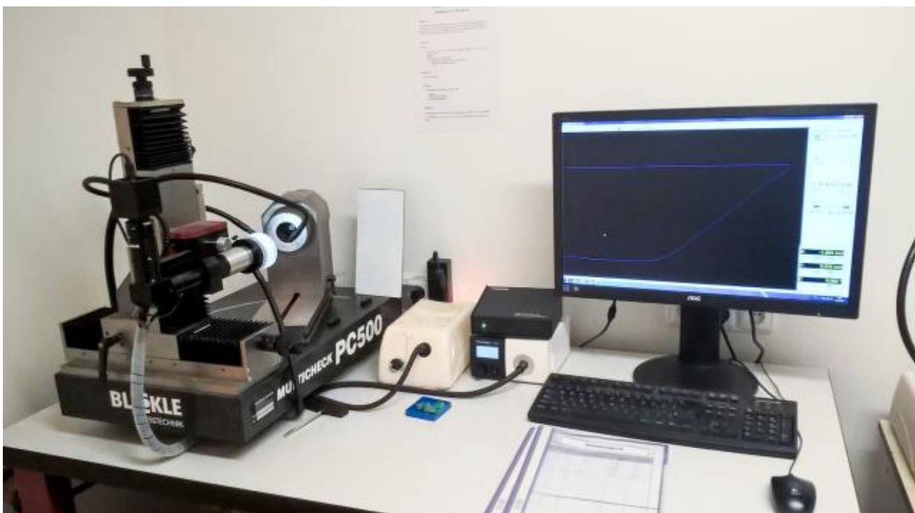
Obr. 18 – Optický mikroskop Multicheck 500 pro vyhodnocování opotřebení s příslušenstvím
