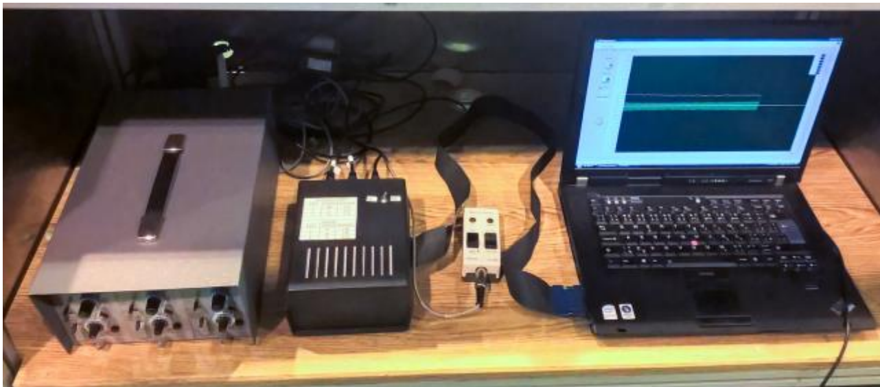
Obr. 17 - Zaznamenávací zařízení pro měření silového zatížení
