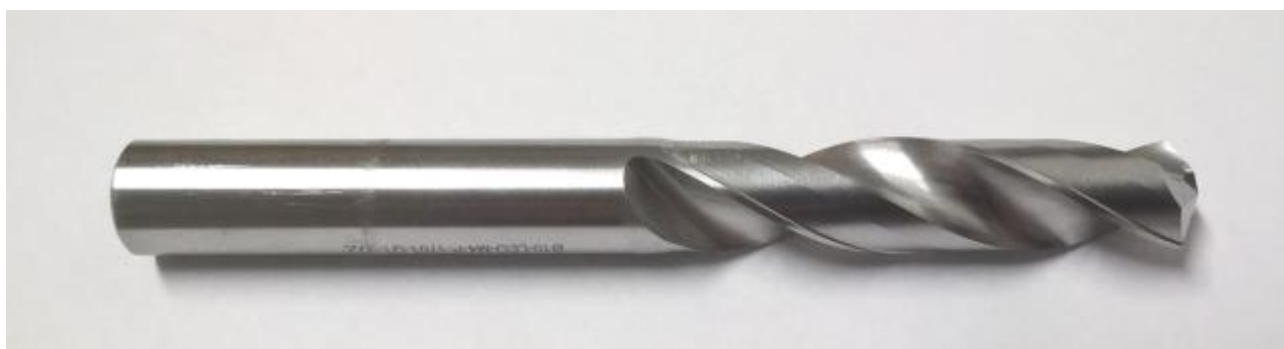
Obr. 13 - Vybroušený vrták připravený pro experiment
