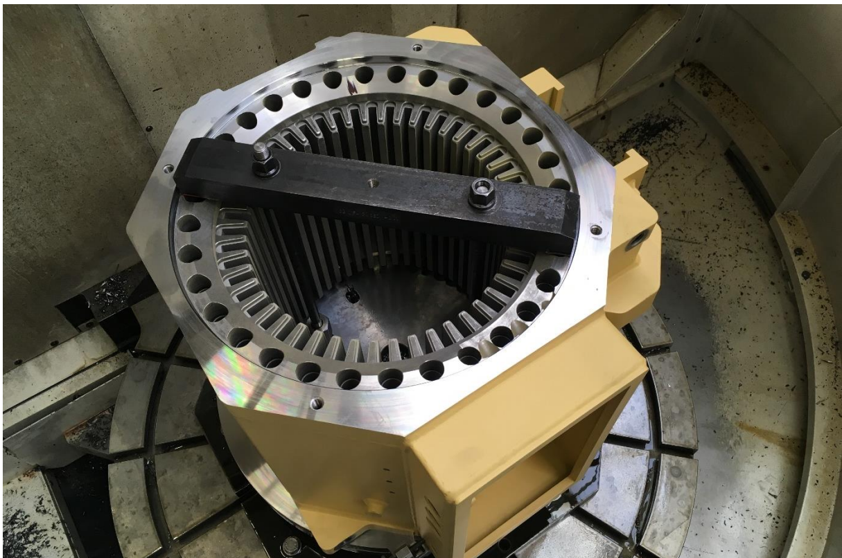
Obr. 18 Stator upnutý pomocí upínek do univerzálního obráběcího centra Deckel Maho
