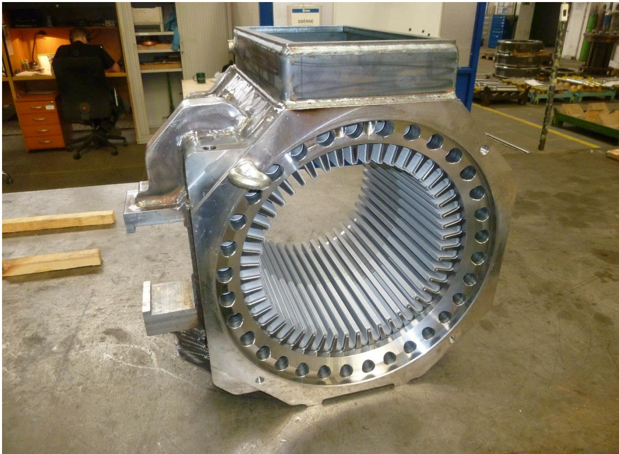
Obr. 11 Svařený stator připravený k obrábění
