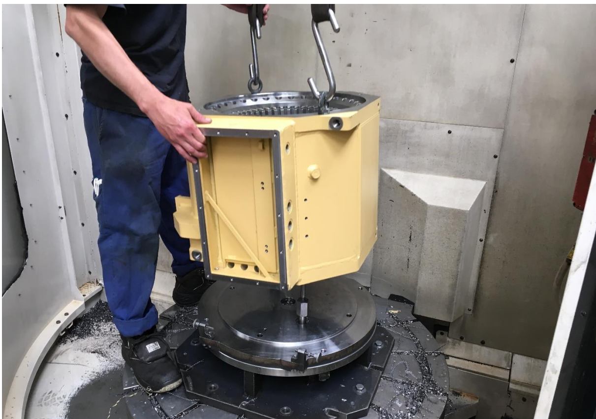
Obr. 16 Příprava upnutí statoru pomocí upínek
