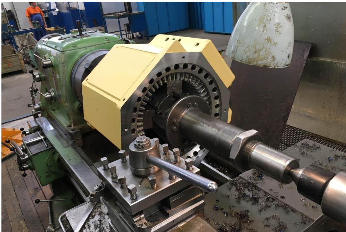
Obr. 13 Stator upnutý pomocí rozpínacího trnu mezi hroty
