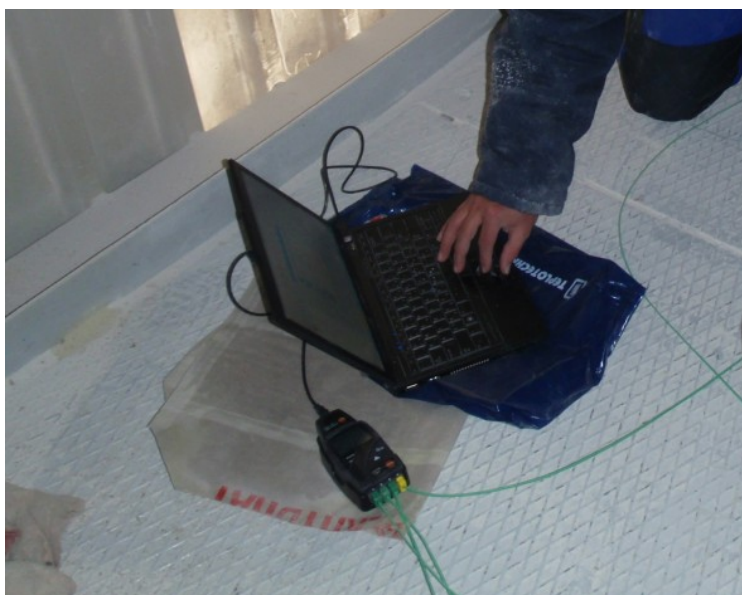
Obrázek č. 3.8 Nastavení záznamníku teploty Testo 177/T4 a spuštění měření
