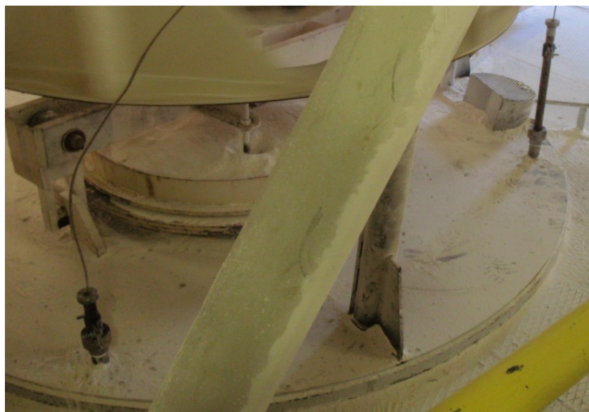
Obrázek č. 3.9 Zasunutě termočlánky do pece Maerz
