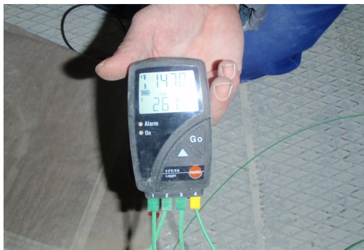
Obrázek č. 3.7 Připojení termočlánku přes kompenzační vedení do teplotního záznamníku Testo 177/T4
