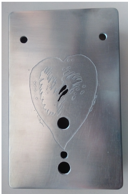
Obr. 29 Efektivní krabice s přeneseným motivem a vyvrtanými otvory
