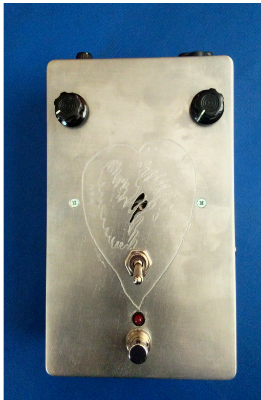
Obr. 30 Rozložení ovládacích prvků na horní ploše efektové krabice
