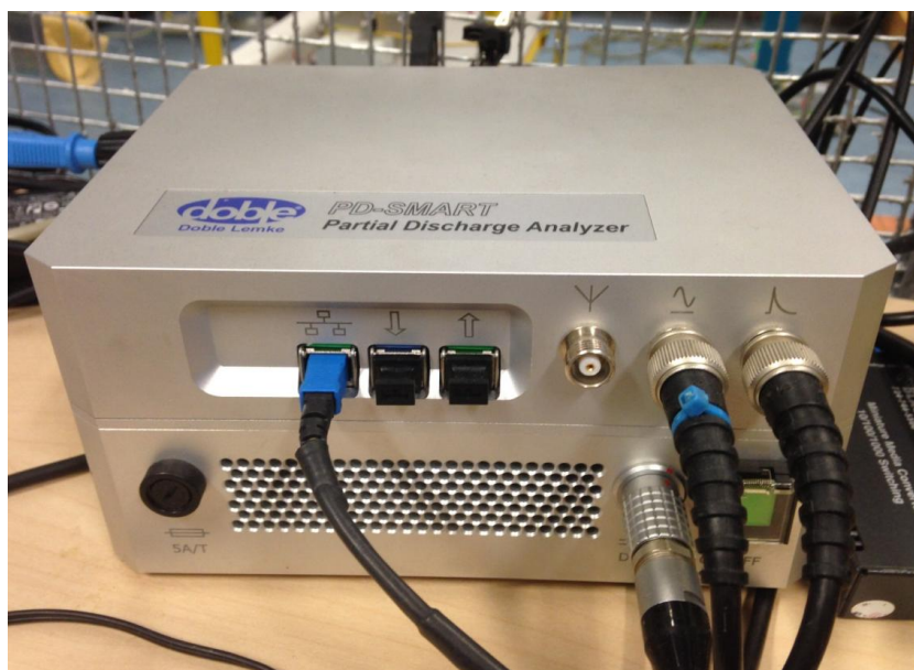
Obr. A.2 Analyzátor částečných výbojů Doble Lemke s koaxiálními přívodními kabely
