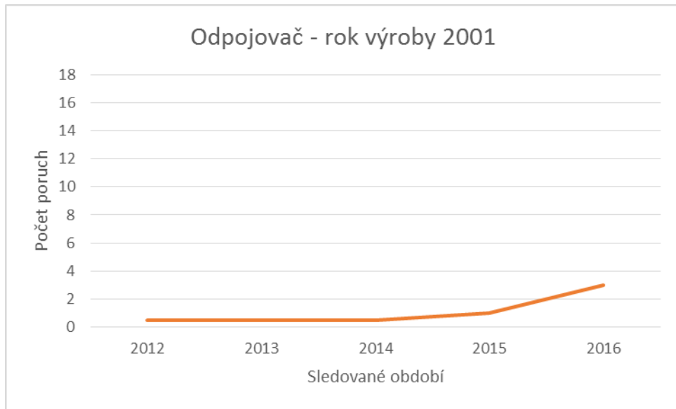
Obr. 4.1.2.2 – Graf vanové křivky odpojovače z roku 2001 ve sledovaném období 2012- 2016
