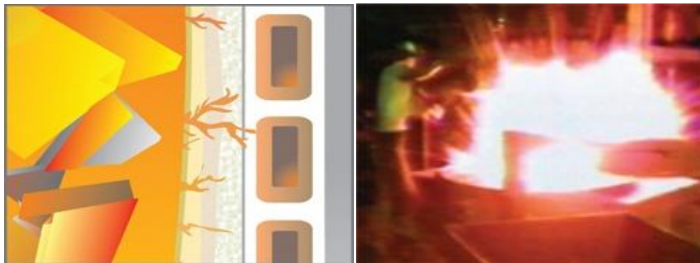
Obr. 2.2.2: a) Působení taveniny na vyzdívku kelímku indukční pece (vlevo), b) Havárie při erupci rozžhavené vsázky mimo kelímek, kontakt taveniny s vlhkostí (vpravo).[15]
