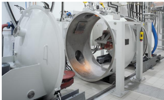
Obr. 3.5.1: Třídílná tavicí komora studeného kelímku: zadní část se studeným kelímkem, prostřední část komory se systémy kontroly atmosféry a měřicími přístroji, a přední víko.[67]
