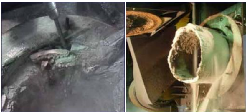
Obr. 2.2.3: a) Uvolnění kelímku, resp. odsekání jeho vrchní části, z indukční pece (vlevo), b) Vysunutí kelímku z indukční pece za pomoci hydraulického vysouvacího zařízení (vpravo).[11]
