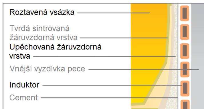
Obr. 2.2.4: Struktura stěny indukční pece, použití nevodivého kelímku. Induktor je oddělen od samotného kelímku vrstvou cementu.[18]
