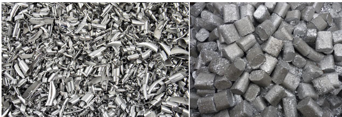
Obr. 2.7.2: Nadrcené hliníkové třísky, v tomto případě jde o tzv. čistý šrot (vlevo,[54]), Brikety ze slisovaných třísek, velikost je určena výrobními možnostmi indukční pece, velikost briket je tedy variabilní v závislosti na velikosti třísek, typu lisu, apod. (vpravo, [53])
