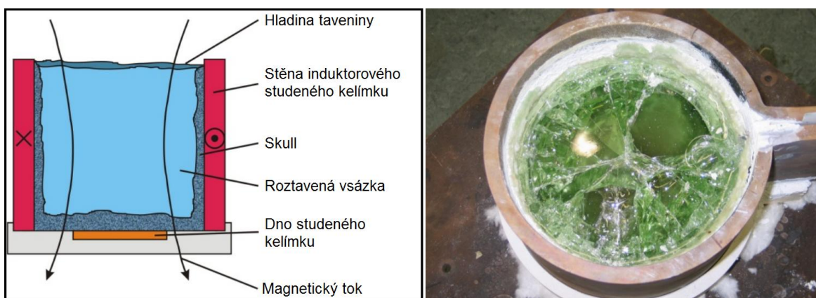
Obr. 3.2.1: Řez induktorovým studeným kelímkem, tento řez však nezohledňuje nutné chladičí kanálky stěny kelímku (vlevo, [39]), Induktorový studený kelímek po tavení skla (vpravo, [39]).
