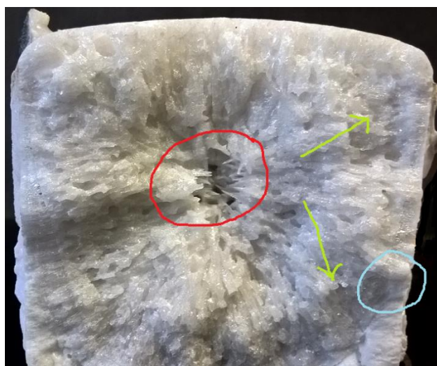
Obrázek 18: Jednorázový odlitek Al_2O_3 ; červená) nejteplejší místo při tavbě, zelená) směr růstu krystalů, modrá) skull vrstva
