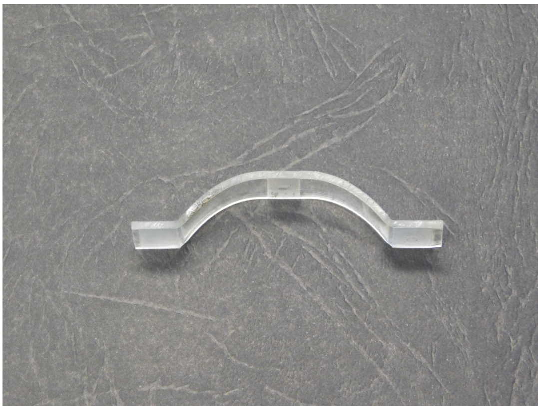
Obr. A9 Vzorek polykarbonátu po skončení měření (pohled z boku)
