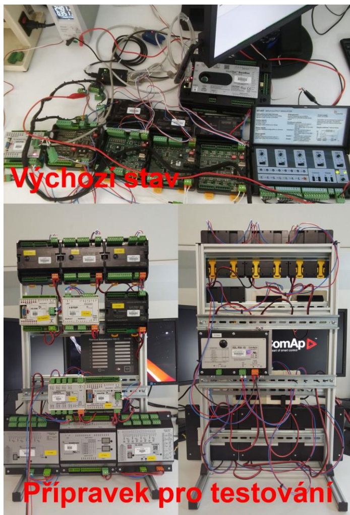
Obr. 3.19 Přípravek pro testování modulů s kontrolérem
