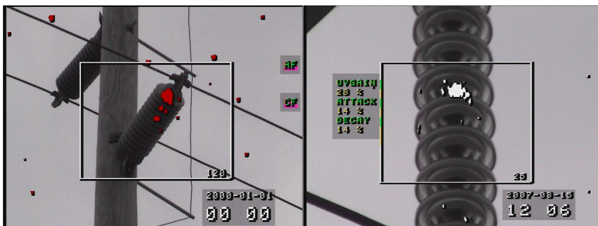
Obr. 2.21 Záběry z kamery CoroCAM 504 při sledování koróny [24]
