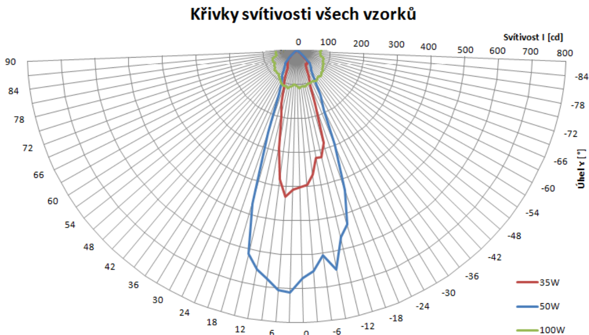
Obr. 4.5. Porovnání křivek svítivosti všech vzorků v polárních souřadnicích
