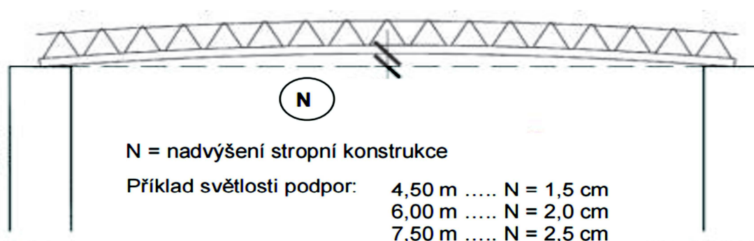
Obrázek 39: Livetherm 250 - nadvýšení stropních nosníků
