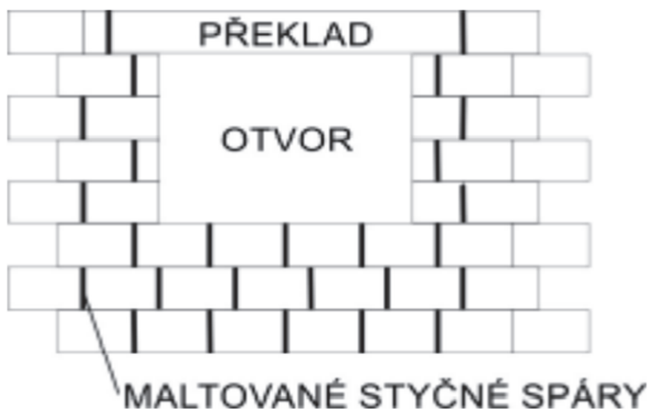
Obrázek 37: Livetherm - opatření kolem otvorů
