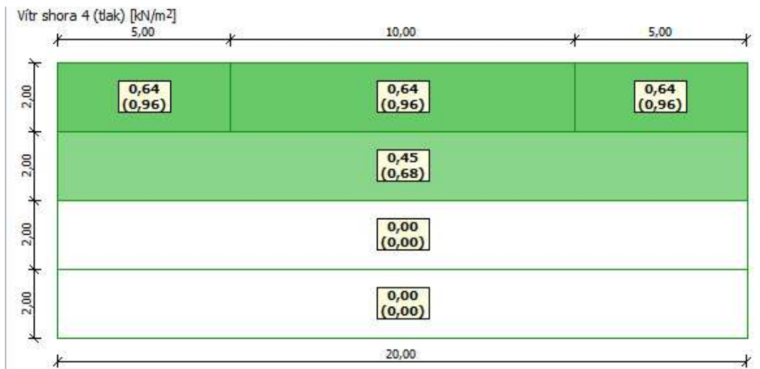
Obr.9 – Zatížení větrem na střechu při směru větru kolmo na hřeben. Varianta tlak/bez zatížení
