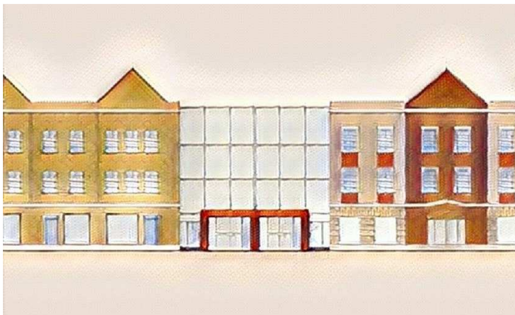
Obr.9 – Varianta tvaru střechy 1 s plochou střechou
