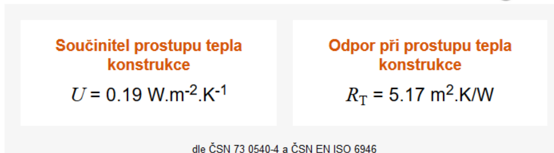
Obrázek 19 Vyhodnocení prostupu tepla podlahovou konstrukcí [ http://stavba.tzb-info.cz/tabulky-a-vypocty/140-prostup-tepla-vicevrstvou-konstrukci-a-prubeh-teplot-v-konstrukci ]
