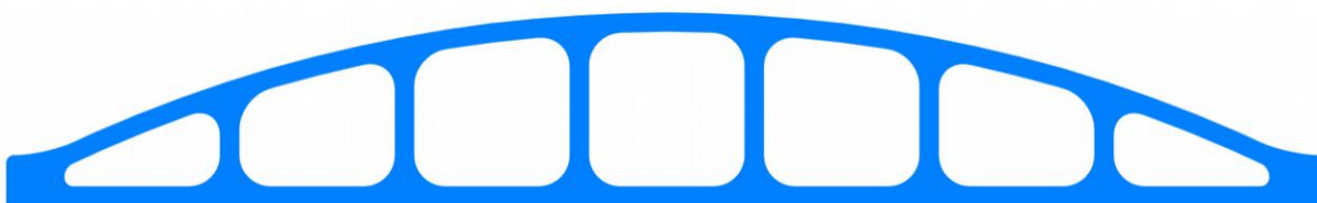
Obrázek 17: Obloukový Vierendeelův nosník
