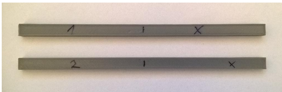
Obrázek 78: Fotografie dvou nosníků pro určení modulu pružnosti
