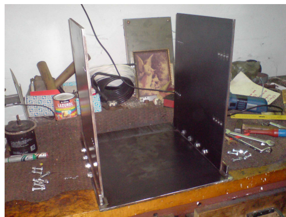
Obr. 2.4 Připevnění boků nádoby
