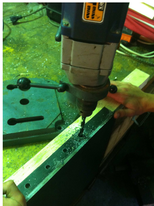
Obr. 2.2 Vrtání děr pro upevnění nádoby
