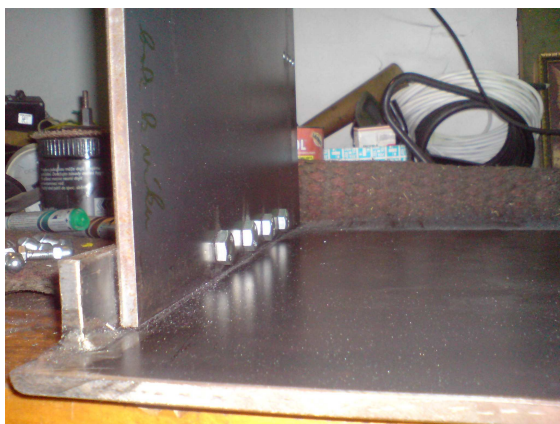
Obr. 2.3 Připevnění dna a boku nádoby
