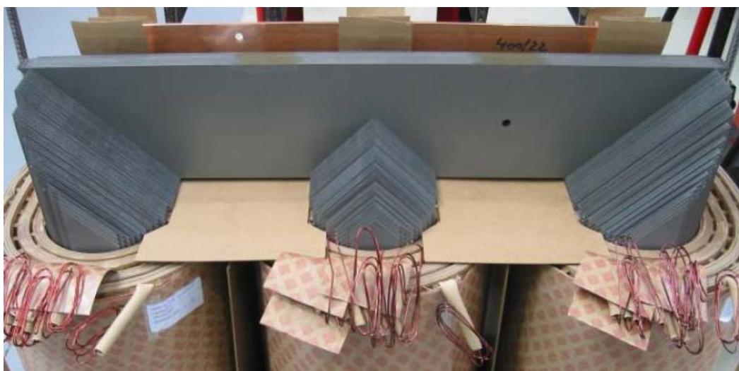
Obrázek 10: Ukázka kompletace vrchního dílu spojky jádrového magnetického obvodu [5]
