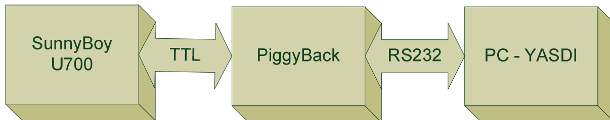
[Obr] 5.3 - Blokové schéma připojení střídače přímo k PC pomocí RS232
