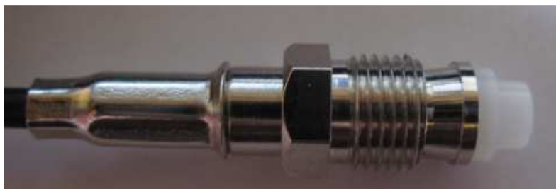
[Obr] 6.13 - Detail F konektoru, kterým se připojuje všesměrová GSM anténa
