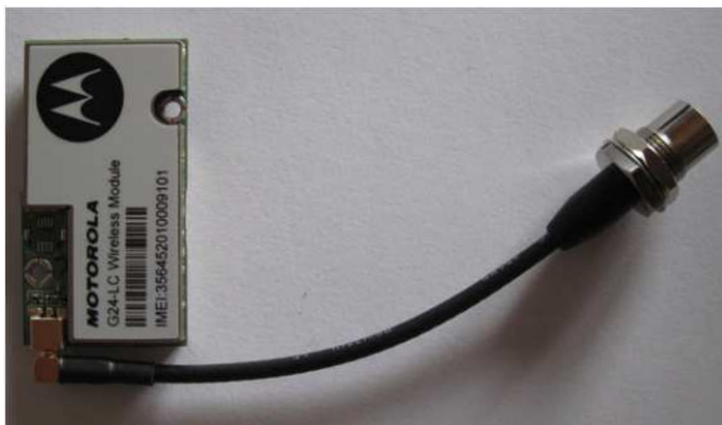
[Obr] 6.15 - Ukázka připojení pigtailu k GSM modulu
