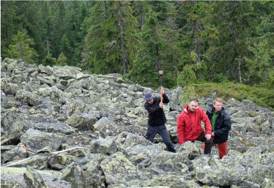
Obr. 43: Buzení seismického signálu pomocí seismického kladiva na kamenném moři. Vlastní foto autora, 2016.
