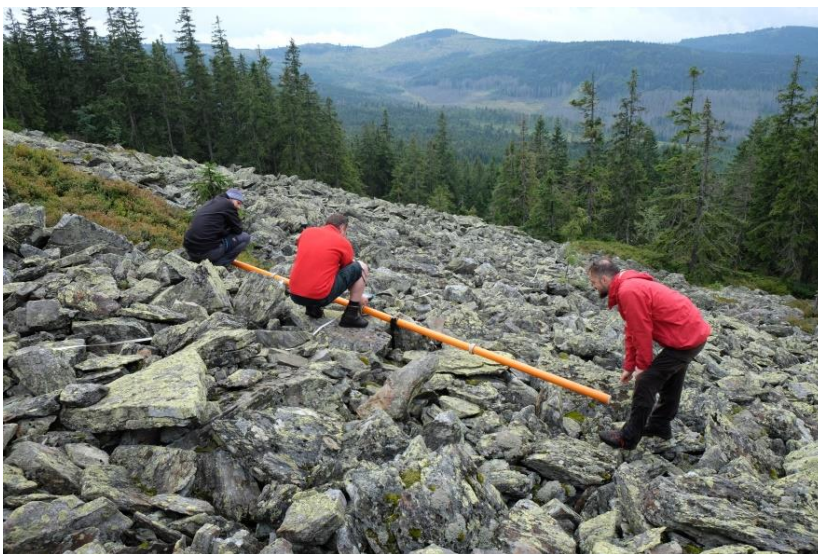
Obr. 31: Ukázka použití DEMS (CMD-Explorer) na kamenném moři. Vlastní foto autora, 2016.
