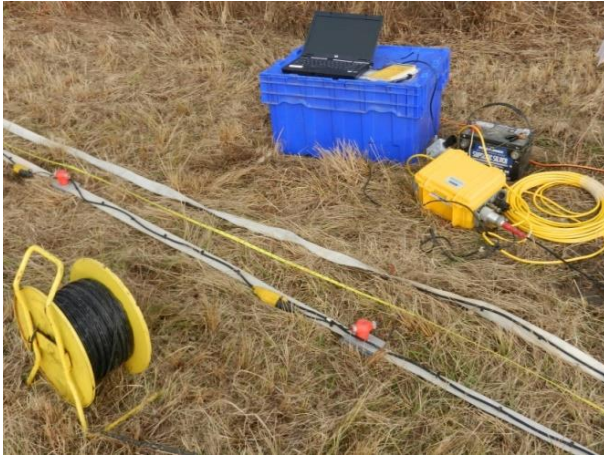
Obr. 40: Aparatura Geode pro SSR průzkum. Převzato z Seismicrental, 2016.
