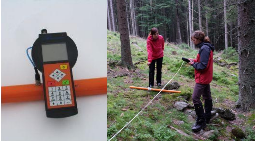
Obr. 29: Řídící jednotka CMD. Převzato z GF Instruments, 2012 a Obr. 30: Použití CMD MiniExplorerer na kamenném moři. Vlastní foto autora, 2016.
