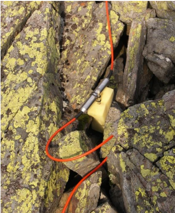
Obr. 50: Využití pěnových hub saturovaných elektrolytem pro zlepšení vodivého kontaktu elektrod s okolním prostředím na kamenném moři v oblasti Skalka. Vlastní foto autora, 2016.
