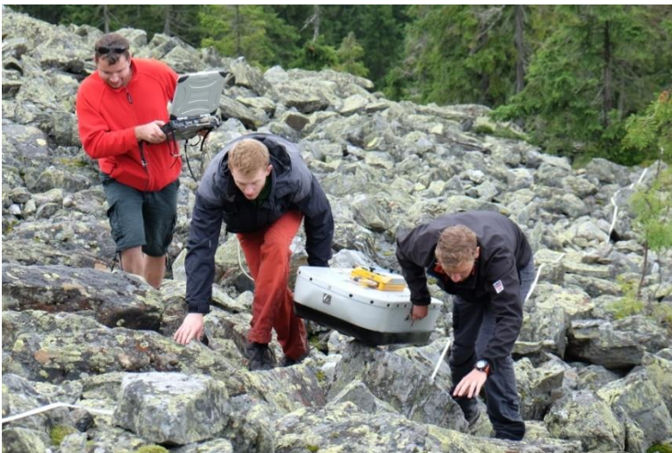
Obr. 21: Ukázka použití georadaru na kamenném moři. Vlastní foto autora, 2016.
