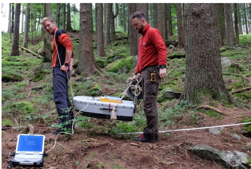
Obr. 53: Aplikace metody GPR v lokalitě Slunečná. Vlastní foto autora, 2016.
