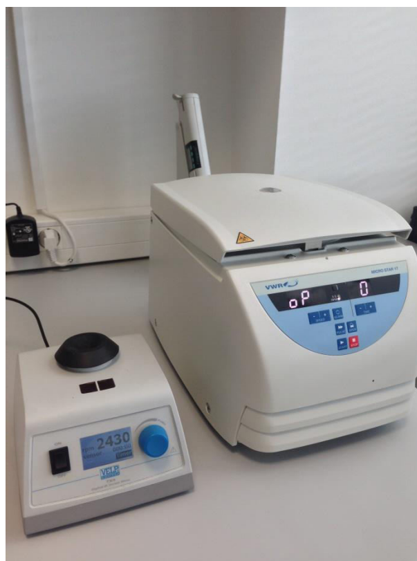
Obrázek 2 – VELP® Scientifica, TX4 Digital IR Vortex Mixer a VWR, Micro Start 17 zdroj: autor
