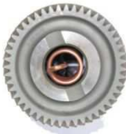
Obr. 4 Například v automobilkách se realizovalo indukčním ohřevem nasazování ozubených kol za tepla. [5]
