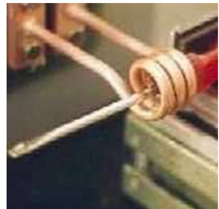
Obr. 6 Svařování kovové části z částí z umělé hmoty, například zatavení kovové části šroubováku s umělou uchopovací částí [6]
