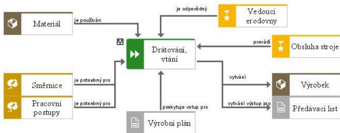
Obrázek 20 – FAD diagram vrtání, drátování
