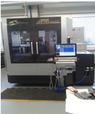
Obrázek 27 – Drátová řezačka SODICK
