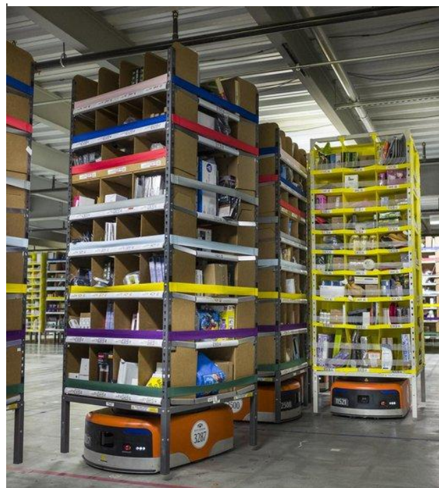
Obr. 1: Roboti Kiva ve skladu Amazonu odvázejí celý regál na místo určení, Zdroj: (E15.cz)
