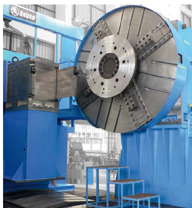
Obrázek 1.6: Detail unášecí hlavy stroje typu SR (zdroj: [28], 2017)
