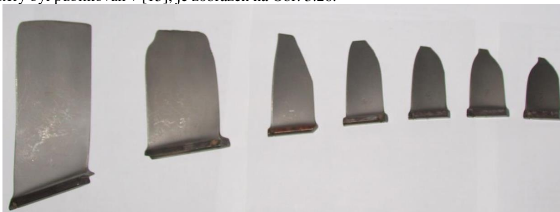
Obr. 3.26 – Opotřebení lopatek axiálního kompresoru 11
