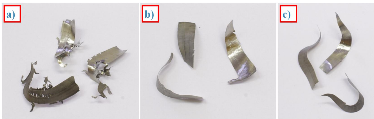
Obr. 6 - 31: Tvar vznikajících třísek po V = 60 \text{ cm}^3 pro: a) r_n = 10 \text{ }\mu\text{m} ; b) r_n = 15 \text{ }\mu\text{m} ; c) r_n = 20 \text{ }\mu\text{m}
