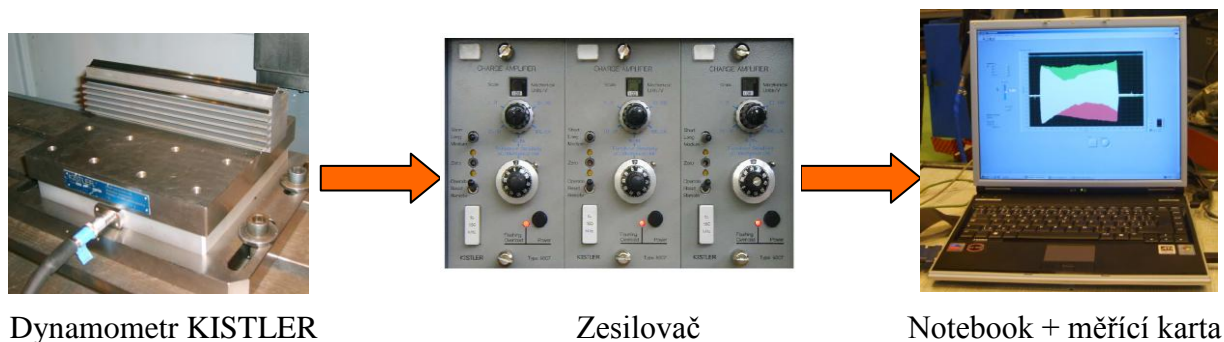
Obr. P 5: Soustava pro měření řezných sil
