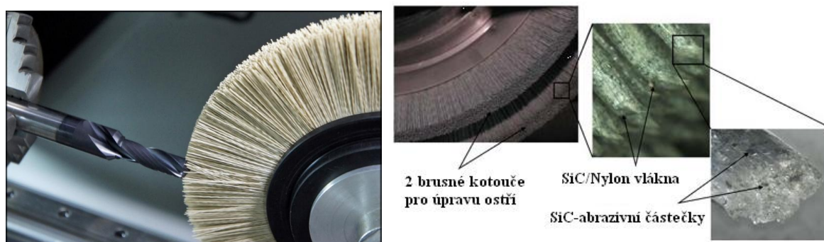
Obr. 3 - 1: a) Ilustrativní obrázek kartáčování [30]; b) detail kartáče [27]
