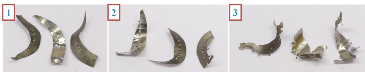
Obr. 6 - 15: Tvar vznikajících třísek při v_c = 200 m/min po 1) 6 cm 3 ; 2) 30 cm 3 a 3) 60 cm 3
